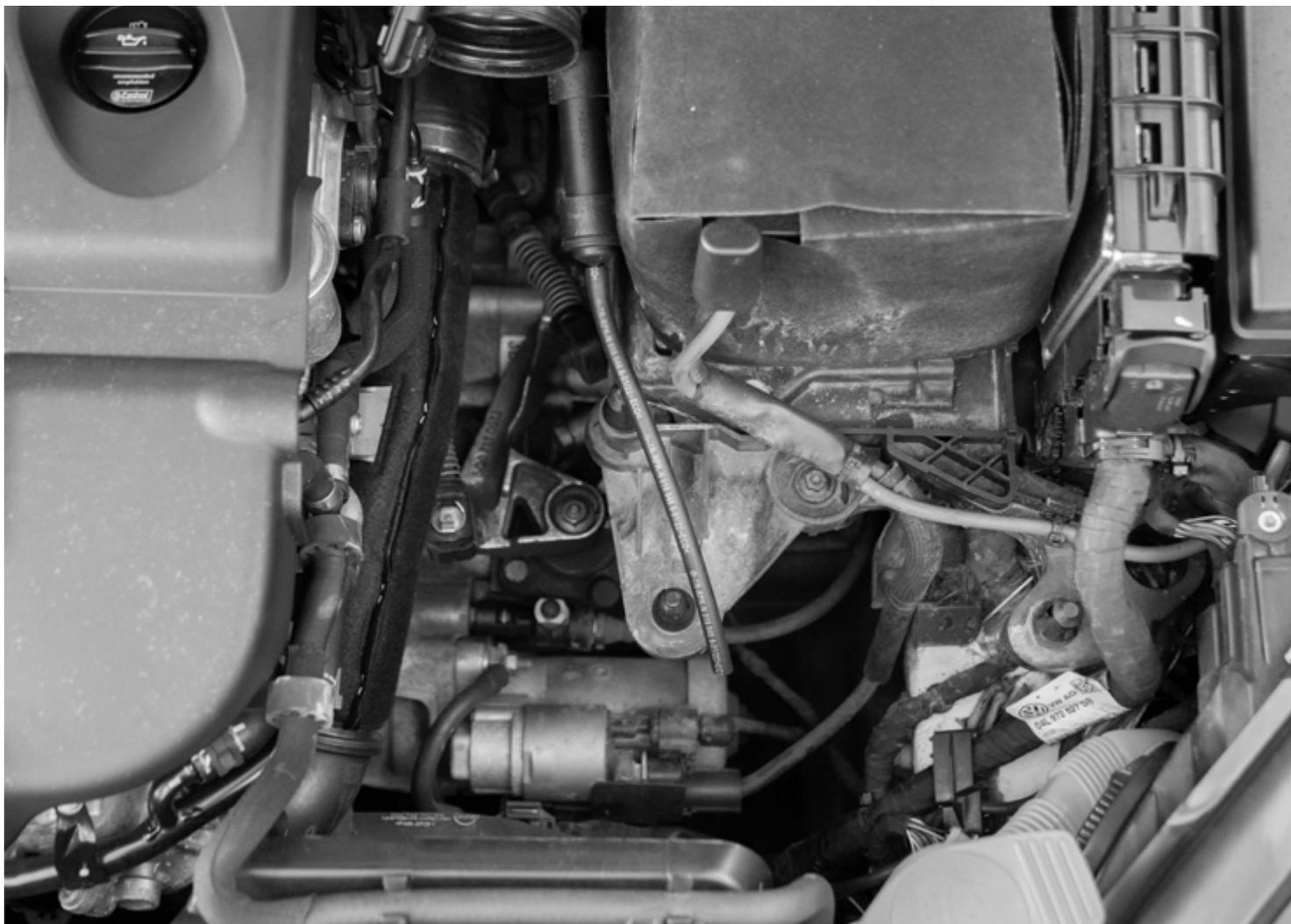
**11.** Das Ventil mit dem Schlauch unterhalb der Ansaugung neben der Batterie entlang legen.
