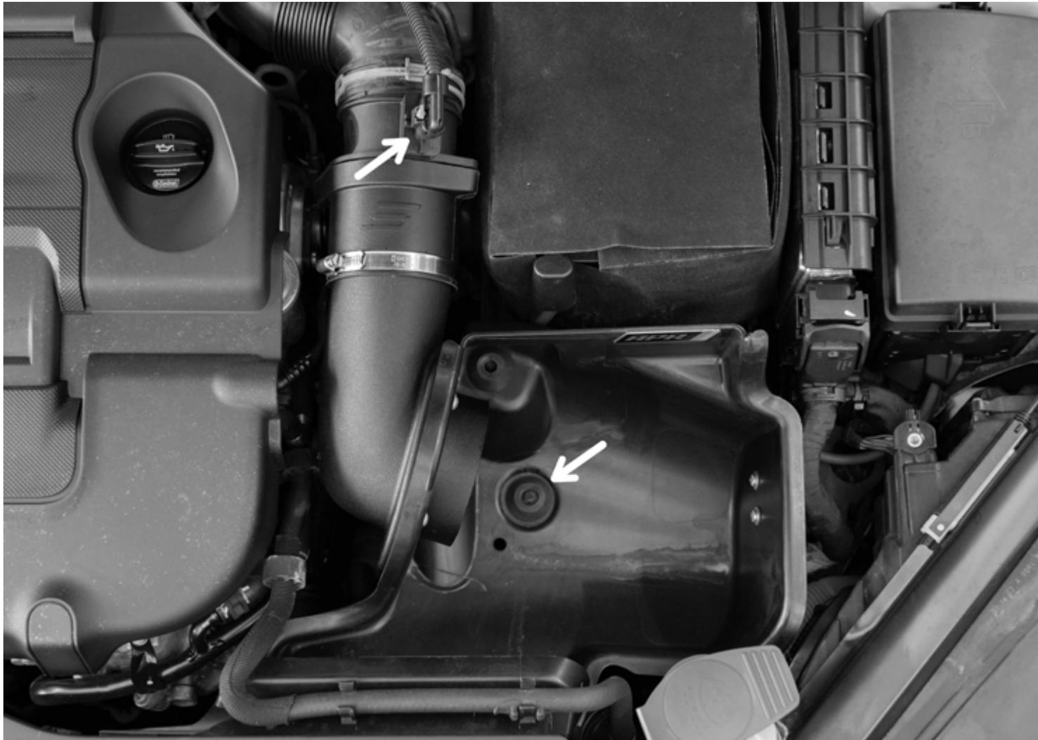
**13.** Setzen Sie die Airbox mit dem Adapter in das Fahrzeug ein und verbinden Sie den Stecker für den Luftmassenmesser.
