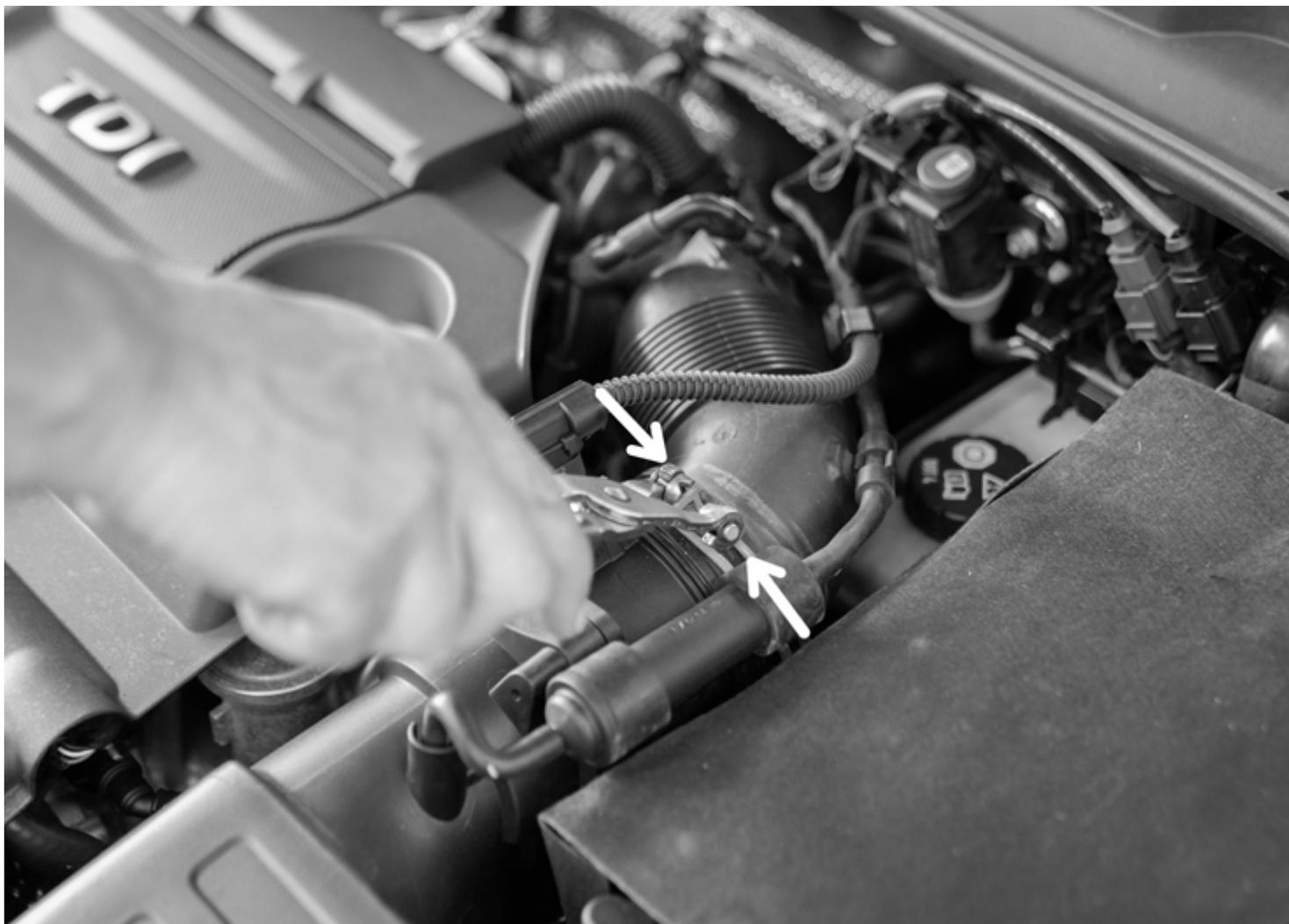
**1.** Lösen Sie die Schelle der die Airbox und den Inlet Schlauch miteinander verbindet.
