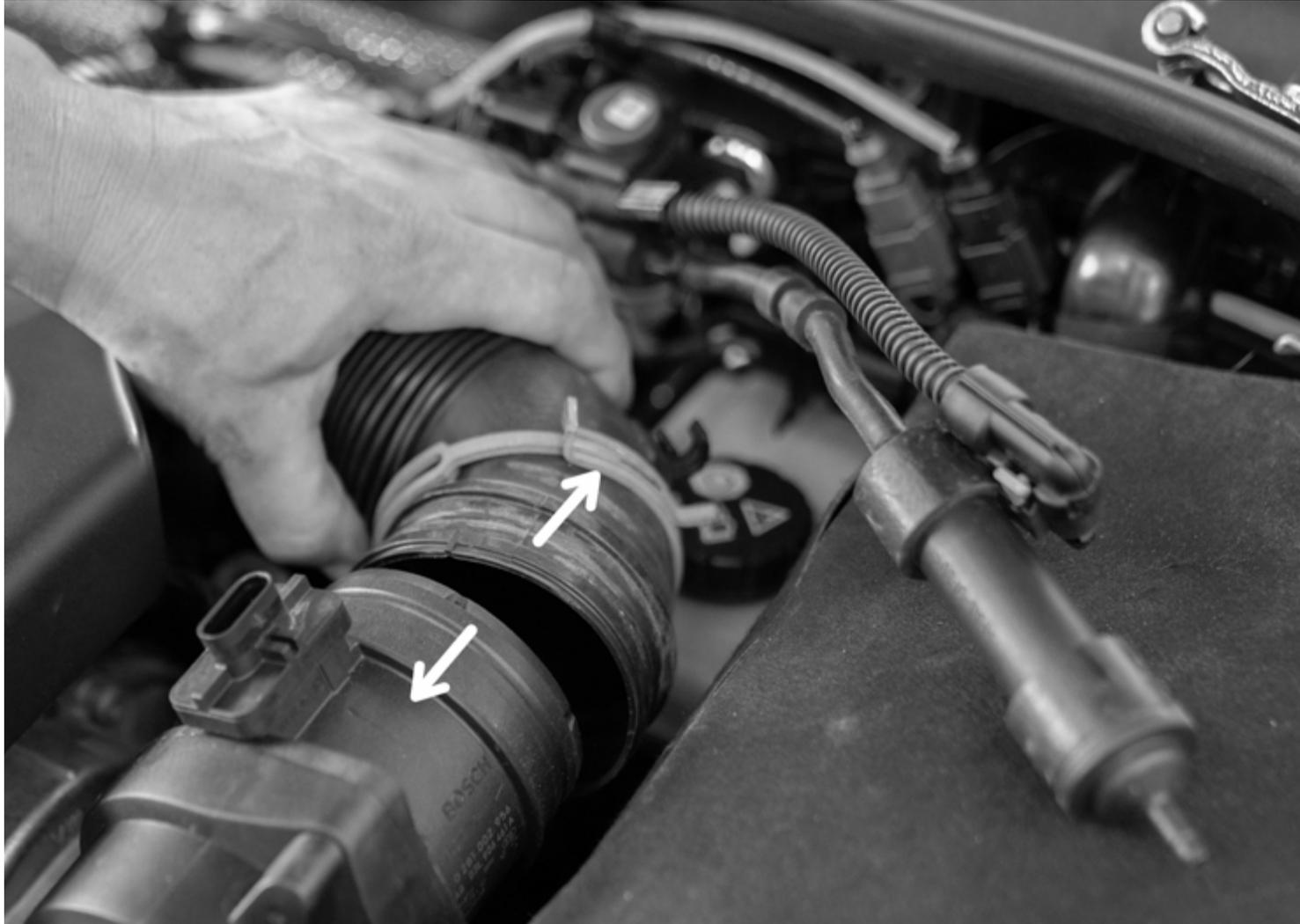
**5.** Trennen Sie den Ansaugschlauch von der Airbox-Einheit.
