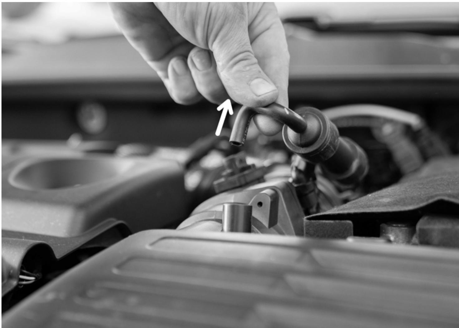
**3.** Ziehen Sie nun den Unterdruckschlauch, der oben an der Airbox befestigt ist ab.
