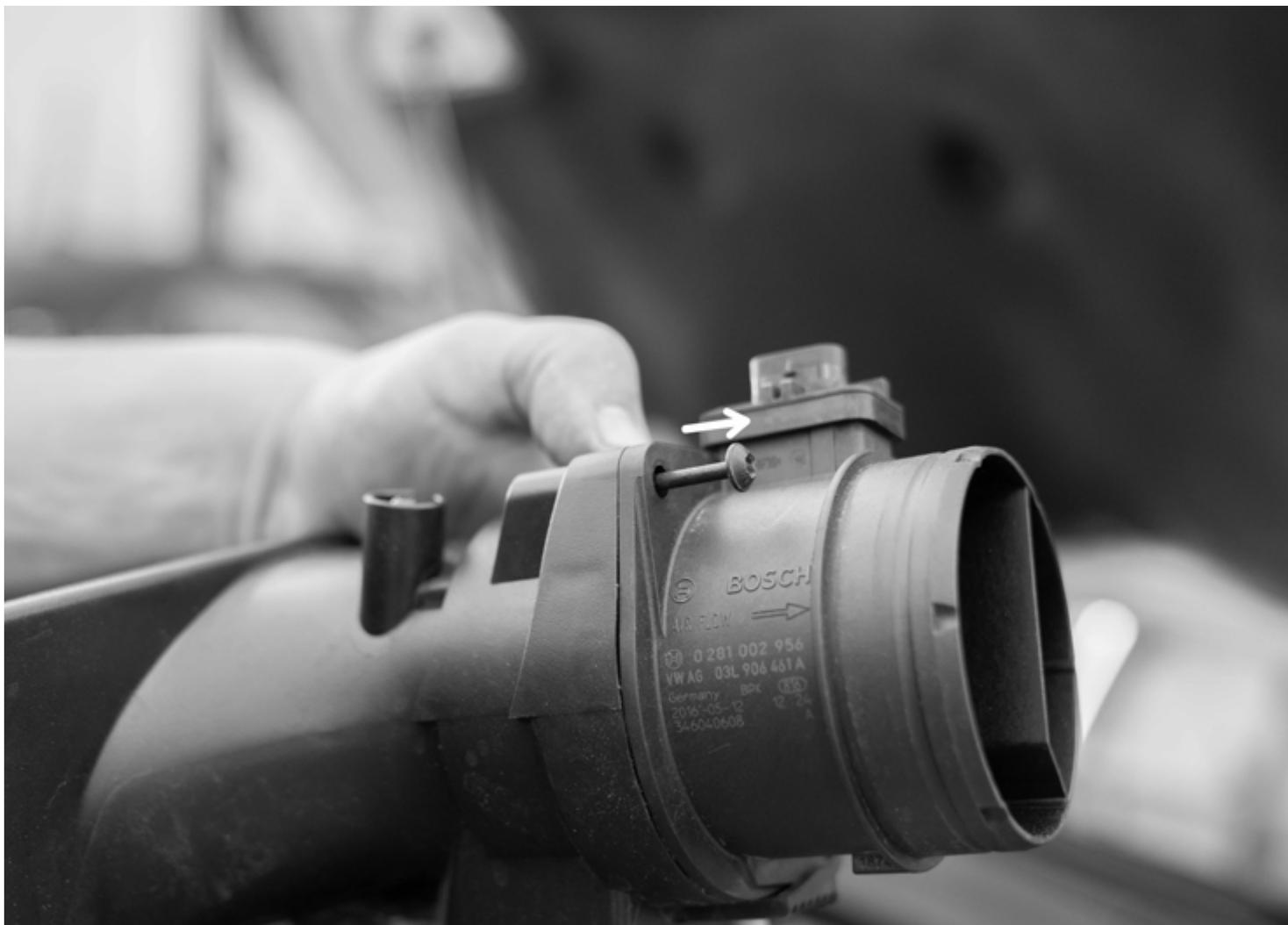
**7.** Drehen Sie die Torx-Schraube aus dem ausgebauten Luftfilterkasten.
